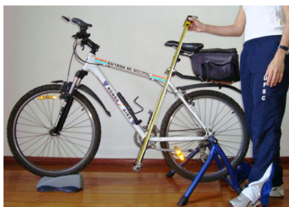
Figura 9 – Ilustração do procedimento da medida da altura do selim.
