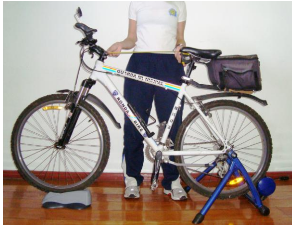
Figura 10 – Ilustração do procedimento da medida do posicionamento horizontal do selim.
